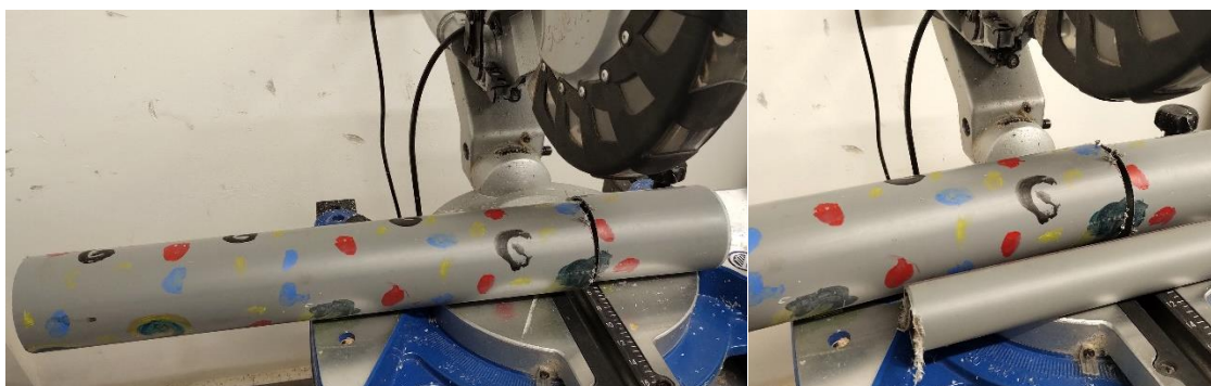
Obrázek 3 Nařezání tubusů, na kotoučové pile, ale ruční pilka na železo stačí
