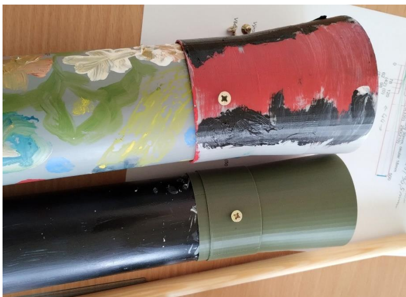
Obrázek 6 Fixování polohy vrutem, předvrtat díрку, aby se tisknuté díly nepoškodily
