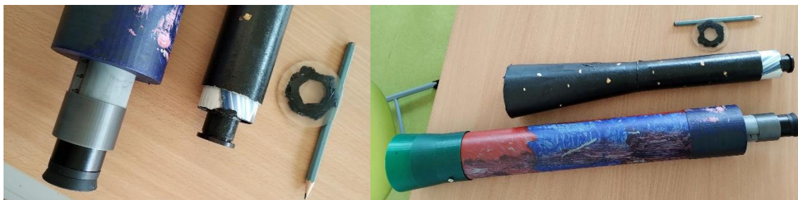
Obrázek 1 Různé konstrukce tubusů, čočka do brýlí z optiky s namalovanou clonou
