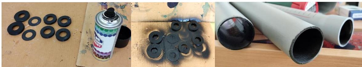
Obrázek 2 Černění clon a okulárového tubusu barvou
